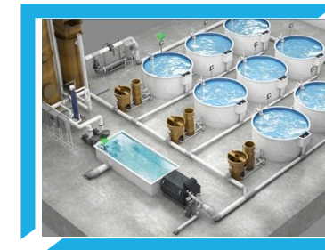
Mô hình nuôi thủy sản sử dụng công nghệ tuần hoàn nước.
